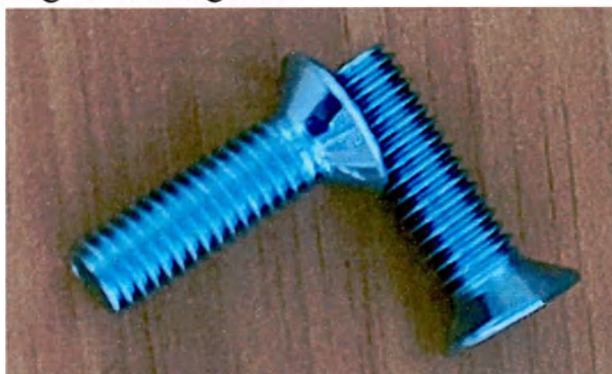
Винт DIN 7991-M6-6g×20-St4.8-galZn
