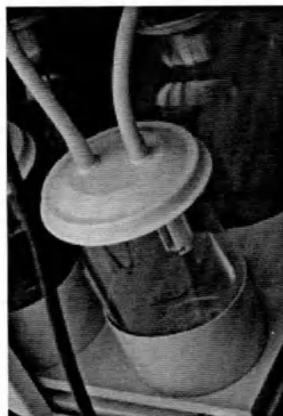
Фотографическое изображение 19 Сосуд для отходов основной 1000 см 3
