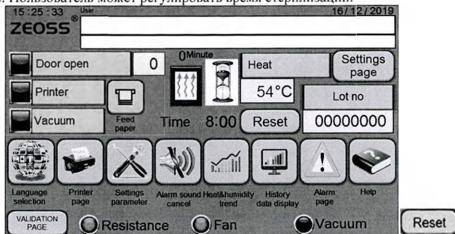
Рисунок 11. Установка времени стерилизации после открытия устройства.
