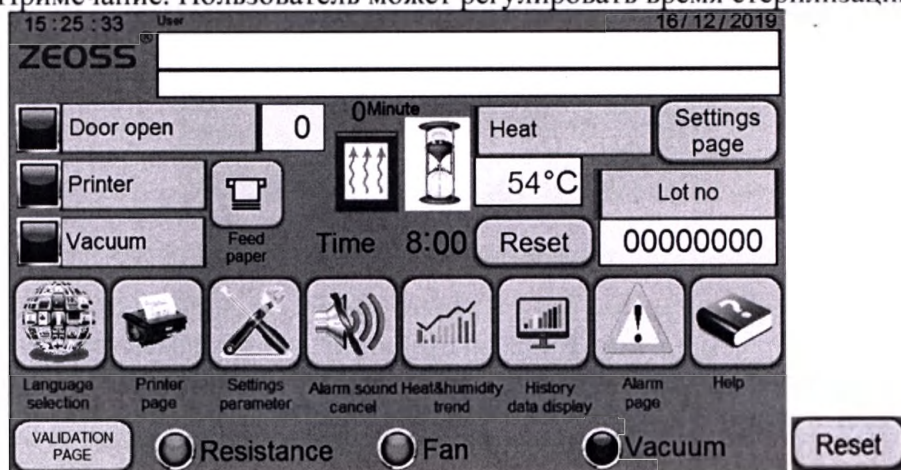
Рисунок 13. Установка времени стерилизации после открытия устройства.
