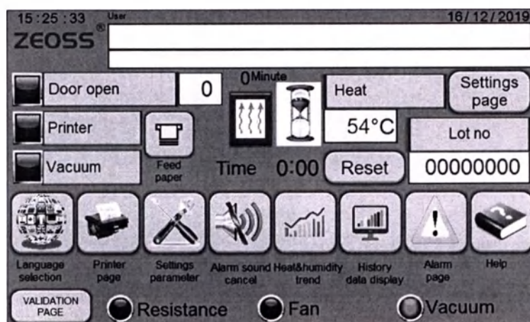
Рисунок 30 Дисплей по окончании процесса стерилизации этиленоксидом
