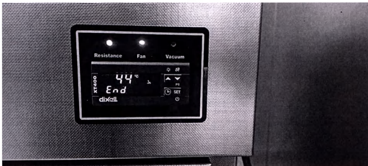
Рисунок 24. Дисплей по окончании стерилизации
