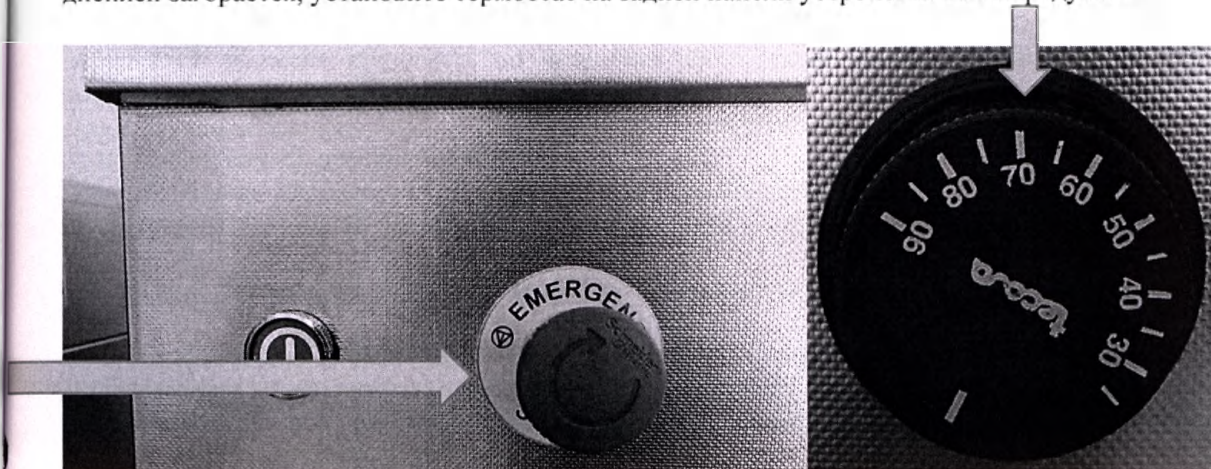
Рисунок 12. Регулировка аварийной кнопки и термостата.
