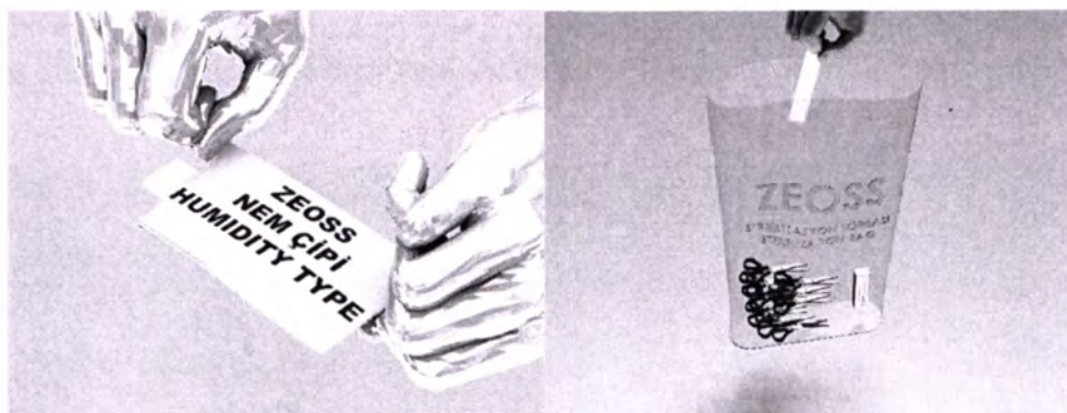
Рисунок 23 Размещение стабилизатора влажности
