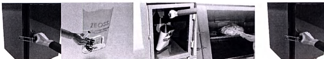
Рисунок 27 Размещение пакета в стерилизаторе для стерилизации этиленоксидом
