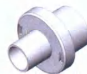
Рис. 2. Общий вид одностороннего клапана
