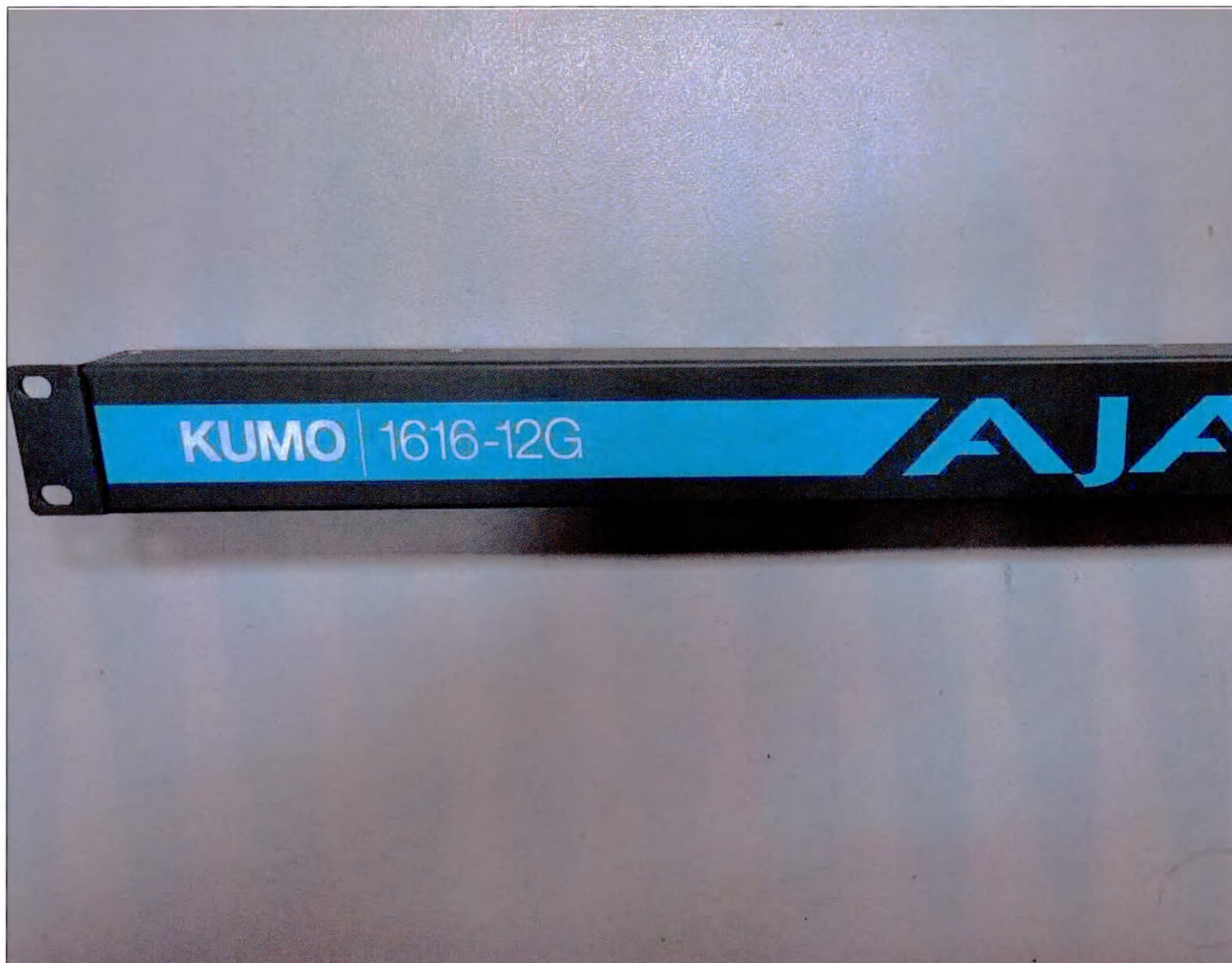
Рис. 57. Принадлежности: Матричный видеокмутатор AJA KUMO 1616-12G с адаптером и кабелем питания переменного тока производства AJA Video Systems, Inc., США, Калифорния
