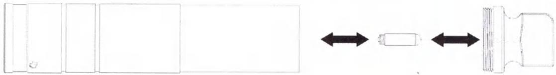
Рисунок 8.2 – Замена лампы в рукоятке для фиброоптического клинка (типа «F.O.»)
