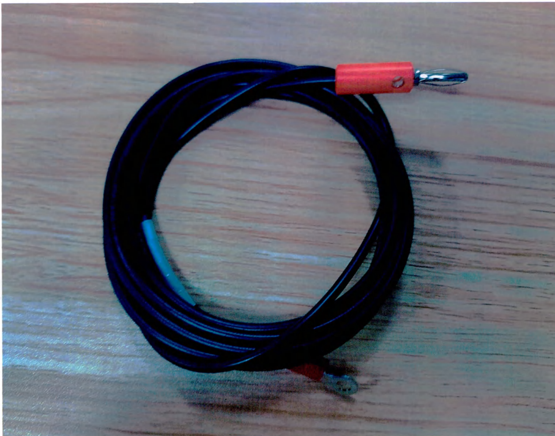
Провод функционального заземления всего устройства
