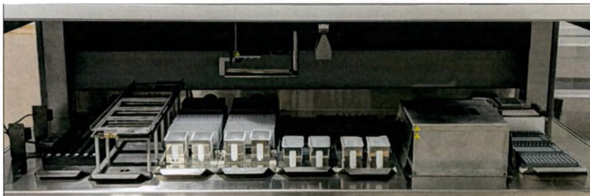
Рис. 29. Рабочая поверхность комплекса: размещение глубоколоночных планшето.
