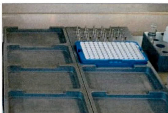
Рис. 51. Установленный ПЦР планшет на рабочем столе комплекса после сканирования.
