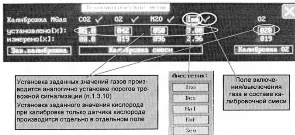
Рисунок 2-33. Калибровка модуля газоанализа
