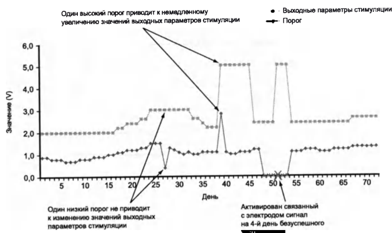
Рисунок 4-7. Влияние изменения порога на выходное напряжение при стимуляции RVAT
