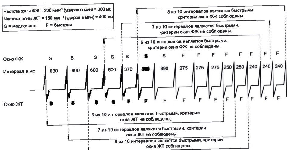
Рисунок 2–4. Взаимодействие окон желудочковой детекции, 2-зонная конфигурация
