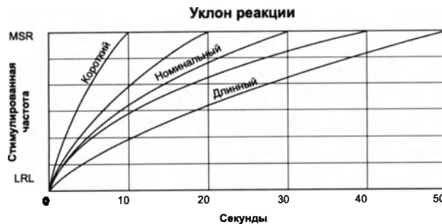
Рисунок 4–13. Время реакции и стимулированная частота
