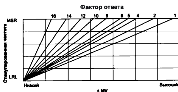
Рисунок 4–19. Связь между запрограммированной настройкой коэффициента ответа и ответом по частоте
