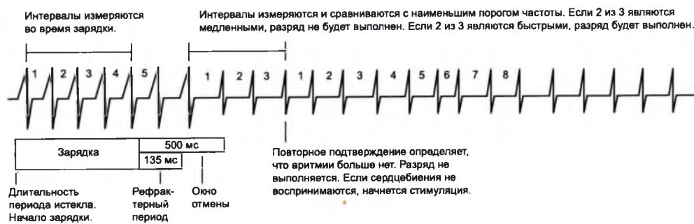
Рисунок 3-24. Синхронизированный разряд запрограммирован на выключение, повторное подтверждение — на включение
