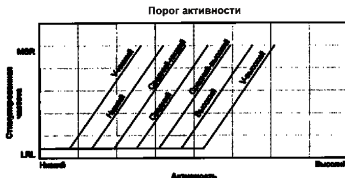
Рисунок 4-13. Порог активности и отклик частоты
