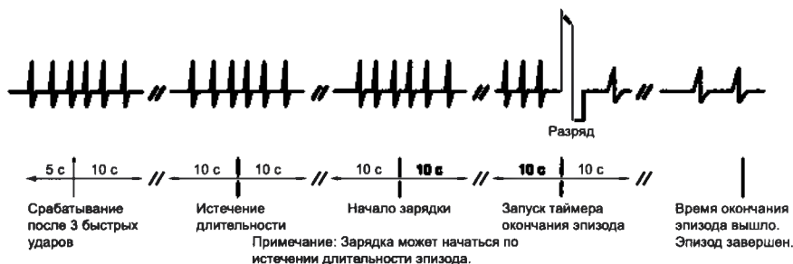
Рисунок 6-3. Связь между сохранением EGM эпизода желудочковой тахикардии и записью графика поверхностной полосы ЭКГ
