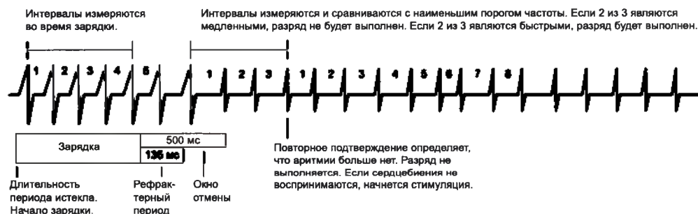
Рисунок 3–24. Синхронизированный разряд запрограммирован на выключение, повторное подтверждение – на включение
