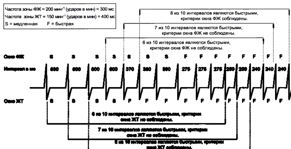
Рисунок 2-4. Взаимодействие окон желудочковой детекции, 2-зонная конфигурация
