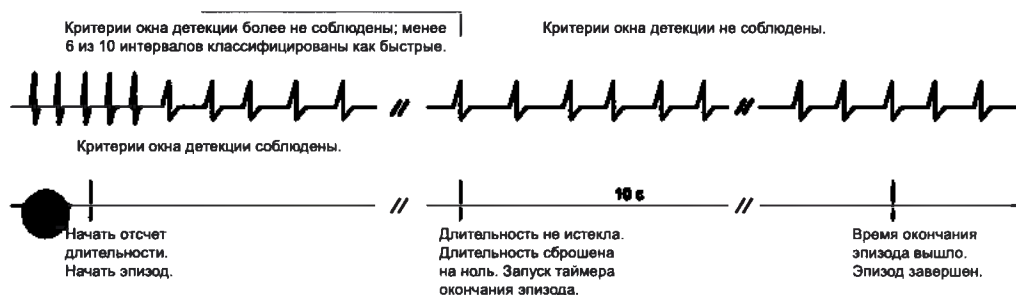
Рисунок 2–14. Non-Treated (Нелеченый) эпизод, желудочковый режим — Monitor + Therapy (Мониторинг + Терапия) или Monitor Only (Только мониторинг), длительность не истекла
