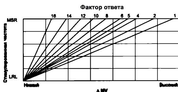
Рисунок 4–21. Связь между запрограммированной настройкой коэффициента ответа и ответом по частоте
