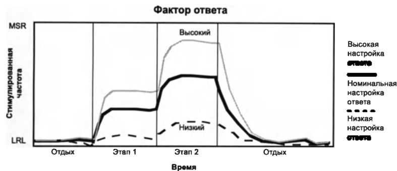
Рисунок 4–22. Влияние настроек коэффициента ответа в двухэтапном тесте с физической нагрузкой
