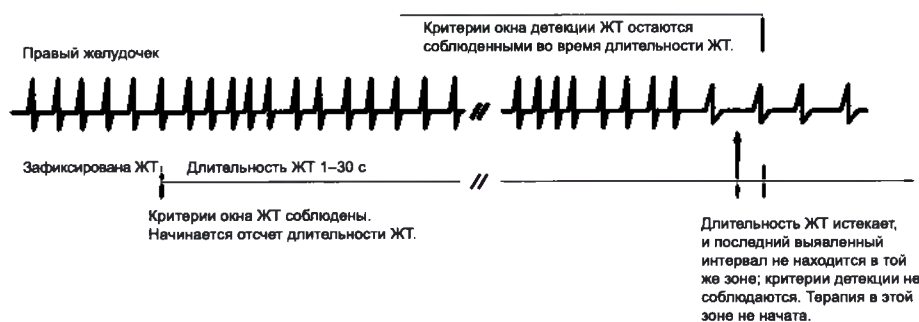
Рисунок 2–6. Последний выявленный интервал
