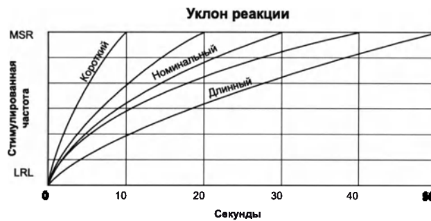
Рисунок 4–13. Время реакции и стимулированная частота
