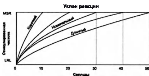
Рисунок 55. Время реакции и стимулированная частота
