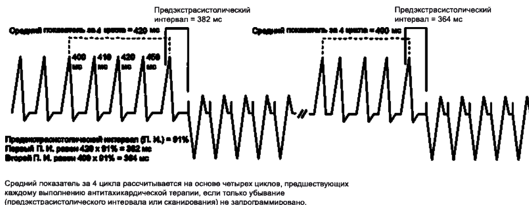
Рисунок 3–13. Параметры Adaptive Coupling Interval (Адаптивный предэкстрасистолический интервал), Coupling Interval Decrement (Уменьшение предэкстрасистолического интервала) и Scan Decrement (Уменьшение сканирования) запрограммированы на 0
