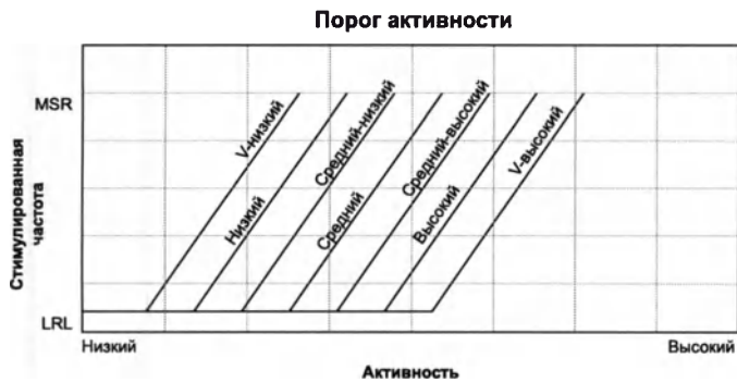
Рисунок 4-11. Порог активности и отклик частоты
