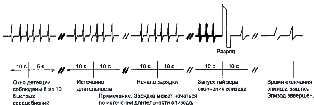
Рисунок 69. Связь между сохранением EGM эпизода желудочковой тахикардии и записью графика поверхностной полосы ЭКГ
