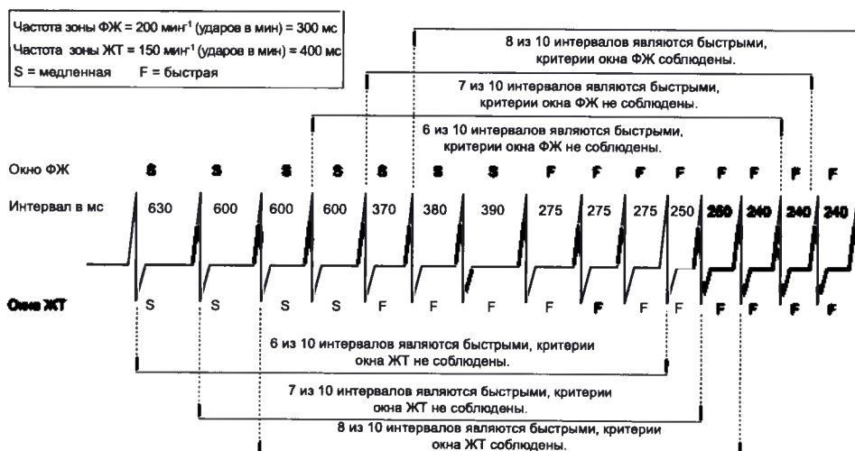
Рисунок 2-4. Взаимодействие окон желудочковой детекции, 2-зонная конфигурация
