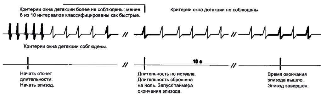
Рисунок 2–14. Non-Treated (Нелеченый) эпизод, желудочковый режим — Monitor + Therapy (Мониторинг + Терапия) или Monitor Only (Только мониторинг), длительность не истекла
