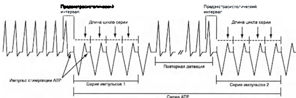
Рисунок 33. Основные параметры ATP терапии: Coupling Interval (Предэкстрасистолический интервал), Burst Cycle Length (Длина цикла серии импульсов), Number of Bursts (Количество серий импульсов) и Number of Pulses (Количество импульсов) в каждой серии
