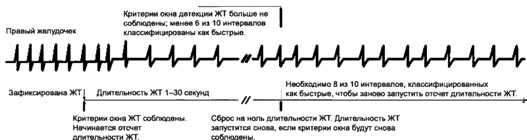
Рисунок 2–6. Последний выявленный интервал
