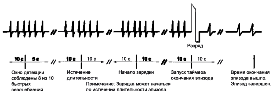
Рисунок 6–2. Связь между сохранением EGM эпизода желудочковой тахикардии и записью графика поверхностной полосы ЭКГ
