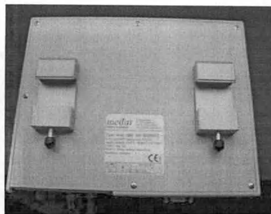
Задняя панель sindi с зажимами для крепления к рейке и табличкой типа аппарата (шильдиком)
