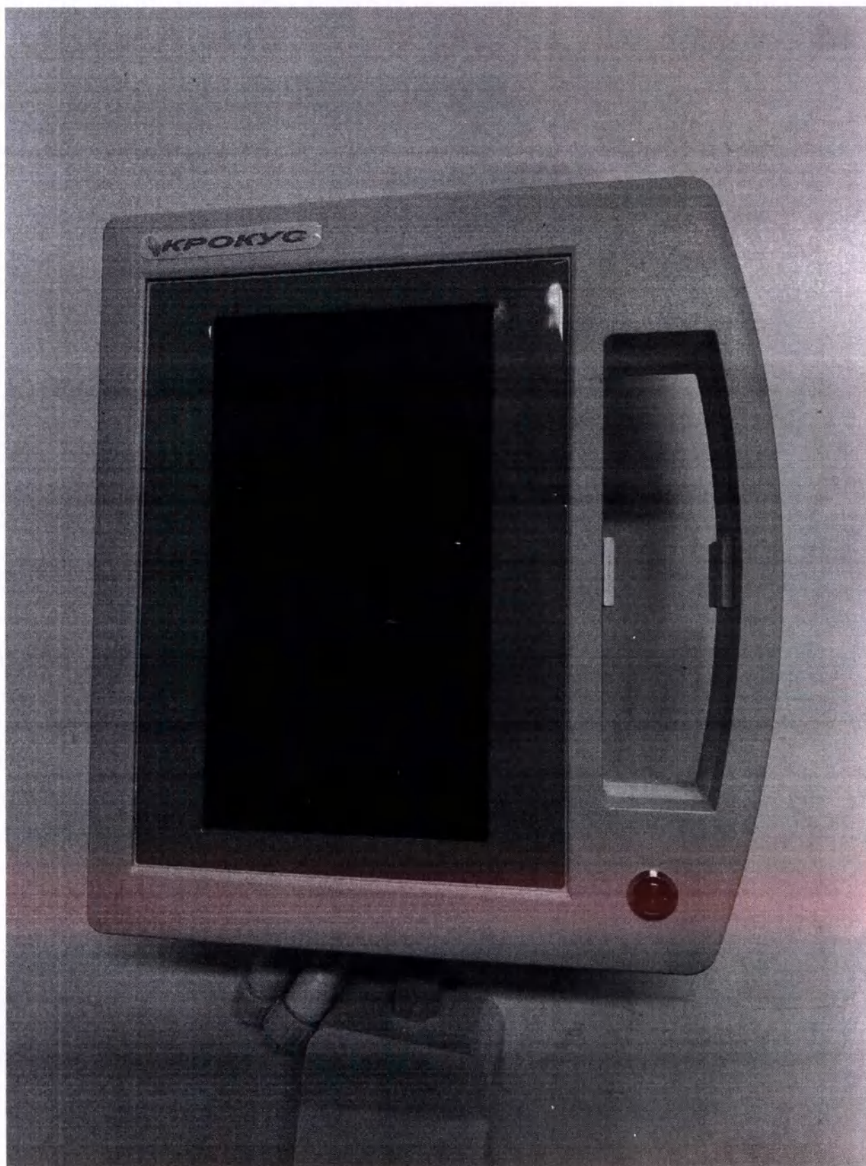
Рис.1.2 Блок регулятора температуры с дисплеем и блоком питания КРОКУС РТ300ДИ
