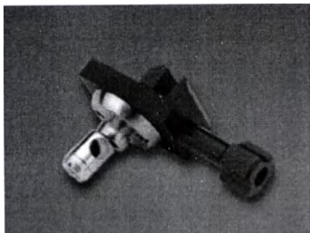
Рис 08 / Стандартный держатель образцов (с адаптером)
