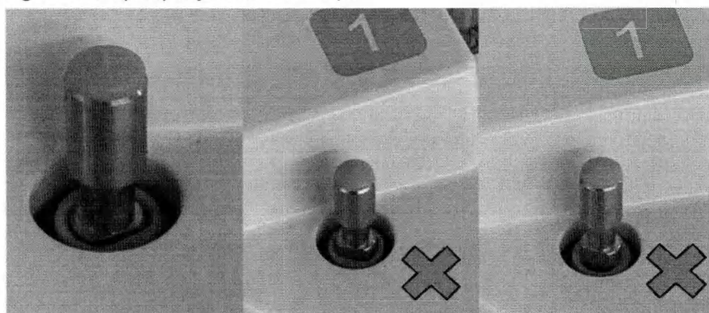
Figure 11.3 Проверка установки миксера
