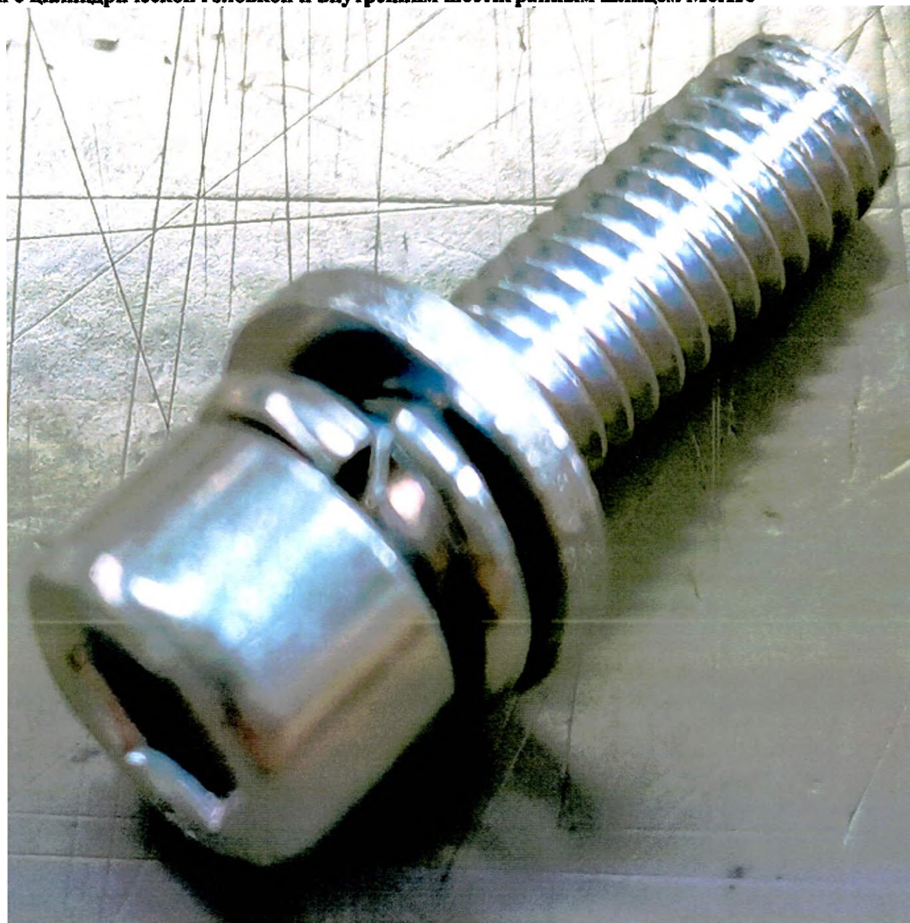
Винт комбинированный с цилиндрической головкой и внутренним шестигранным шлицем М6Х16
