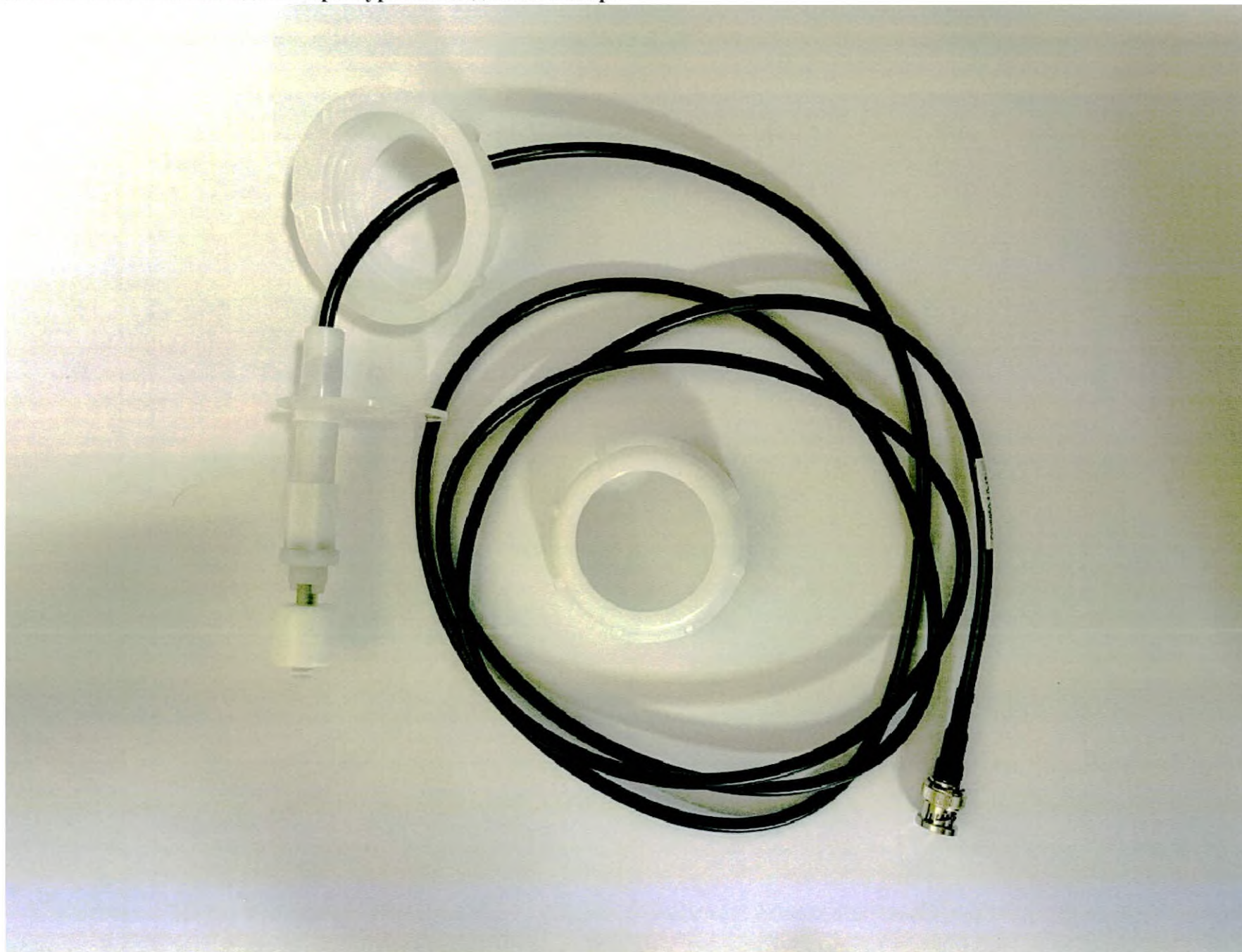
Крышка для емкости сливной с детектором уровня жидкости в сборе
