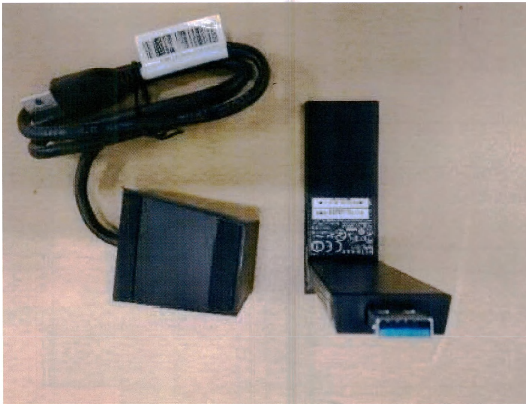
Рисунок 35. Устройство для беспроводной передачи данных – Wi-fi activation
