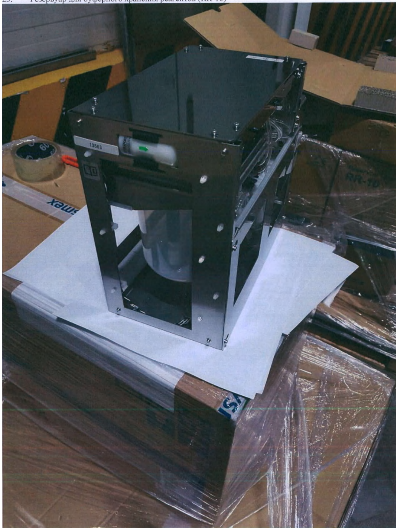
23. Резервуар для буферного хранения реагентов (RR-10)
