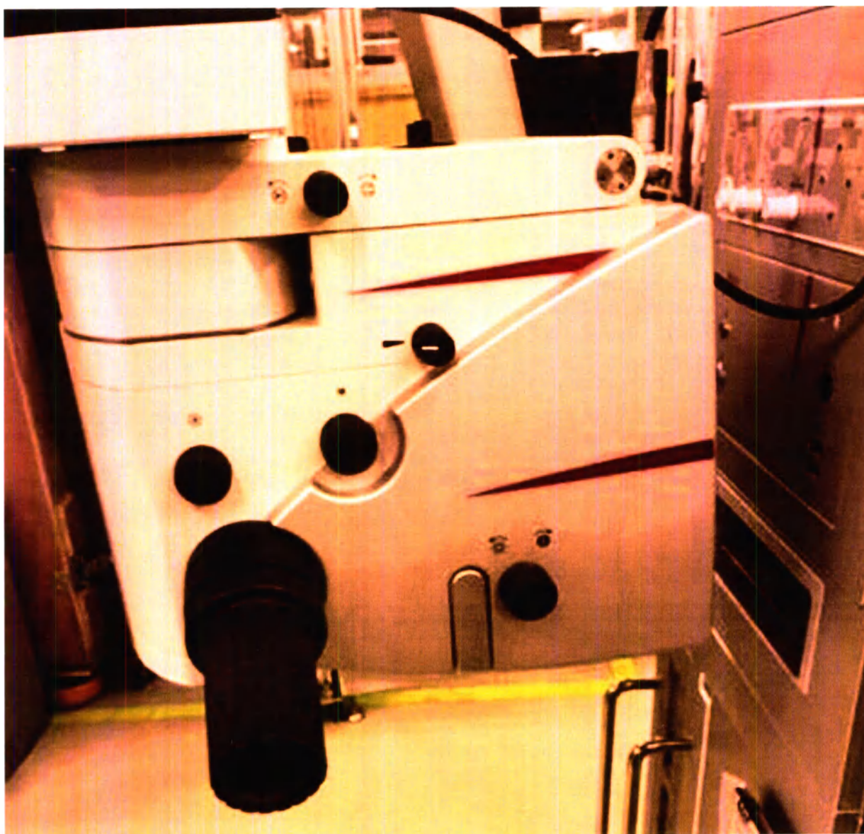
Рисунок 102 – Блок микроскопа оптический с ХУ модулем, механизмом фокусировки и наклона.
