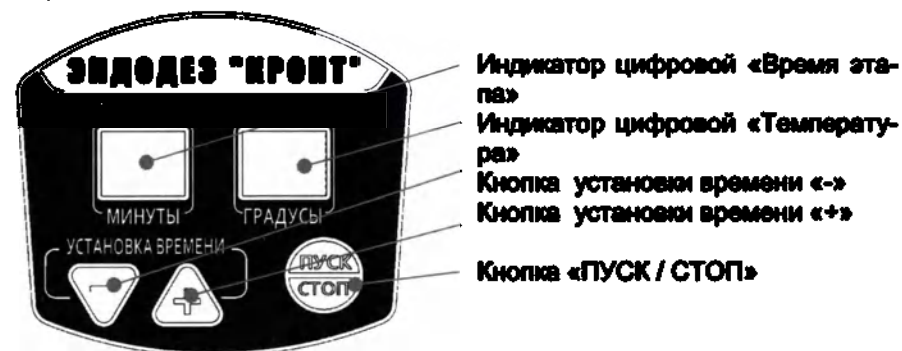
Рис.15 Панель управления блока питания и управления
