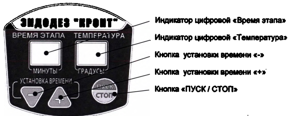
Рис. 14 Панель управления блока питания и управления
