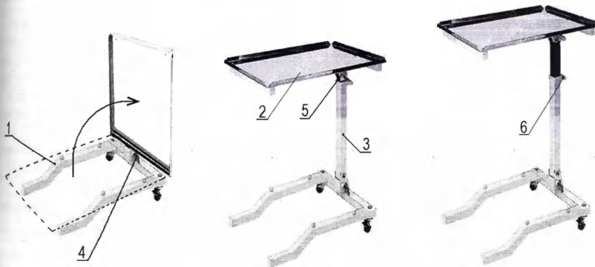
1 – основание; 2 – столешница; 3 – стойка телескопическая; 4, 5, 6 – фиксаторы
