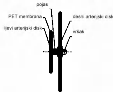
Sl. 1. Struktura PFO okludera CeraFlex™
