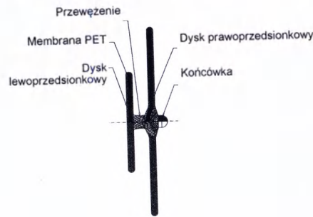
Rycina 1. Konstrukcja okludera PFO CeraFlex™
