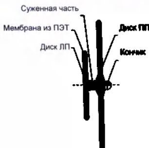
Рис. 1. Структура окклюдера ООО CeraFlex™
