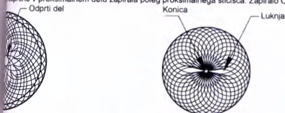
Slika 2. Sestava zapirala CeraFlex™ za prehodni ovalni foramen
