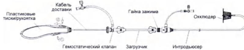
Рис. 7. Изображение высвобождения окклюдера
