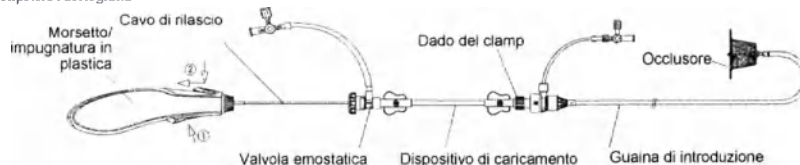
Figura 7. Illustrazione del rilascio dell'occlusore
