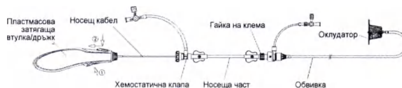
Фигура 7. Изображение на освобождаване на оклудатора
