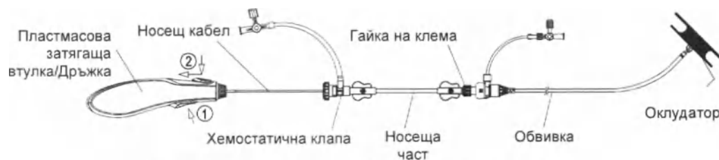
Фигура 9. Изображение на освобождаване на оклудатора
