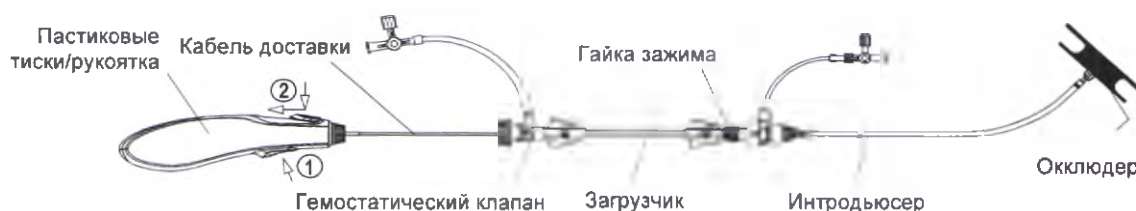
Рисунок 9. Изображение высвобождения окклюдера
