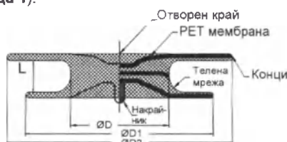
а) Оклудатор за предсърден септален дефект CeraFlex™
