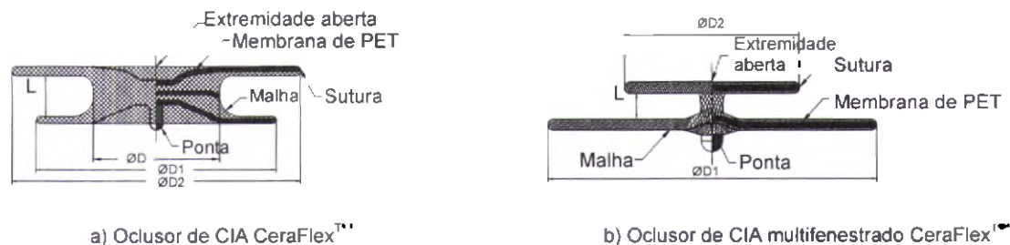
Figura 4. Oclisores de CIA CeraFlex™
