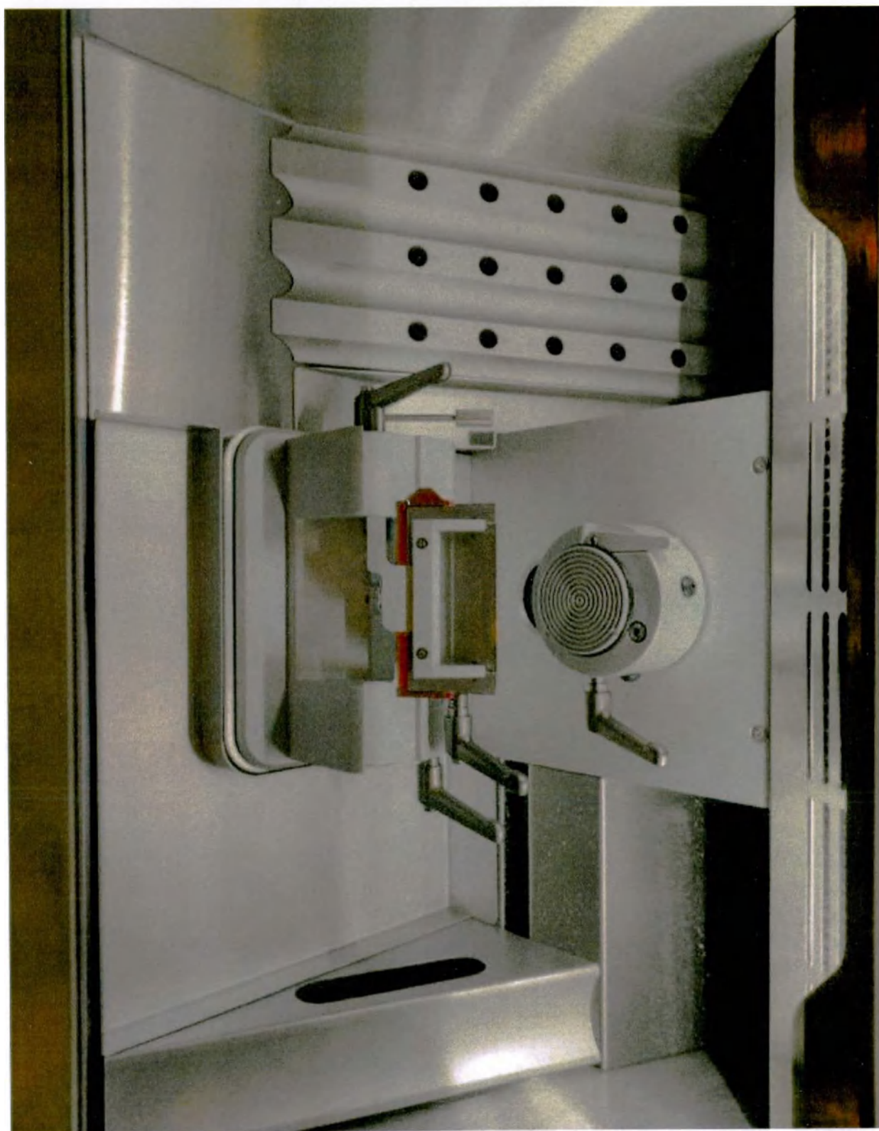
Автоматический ротационный микротом, арт. 32001002 (MNT)
