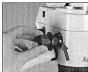
Регулятор увеличения с двух сторон, ступени: 6,4, 10, 16, 25, 40x
