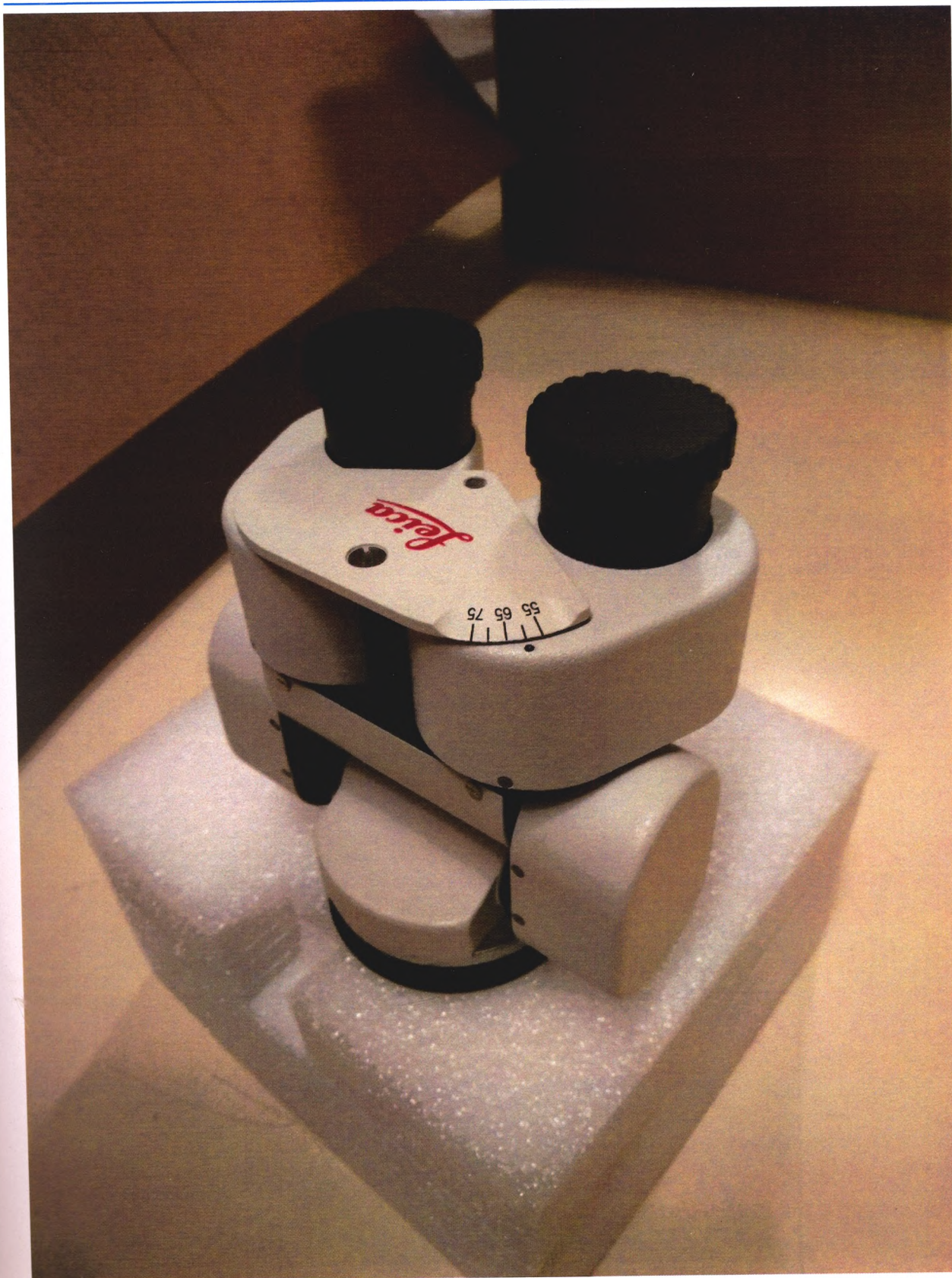
Рисунок 8 – Тубус бинокулярный с изменяемым углом наклона 30^{\circ} - 150^{\circ}/0^{\circ} - 180^{\circ}/5^{\circ} - 5^{\circ}/45^{\circ} .
