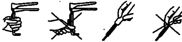
Рисунок 8 – Правильный и неправильный захват инструмента рукой.
