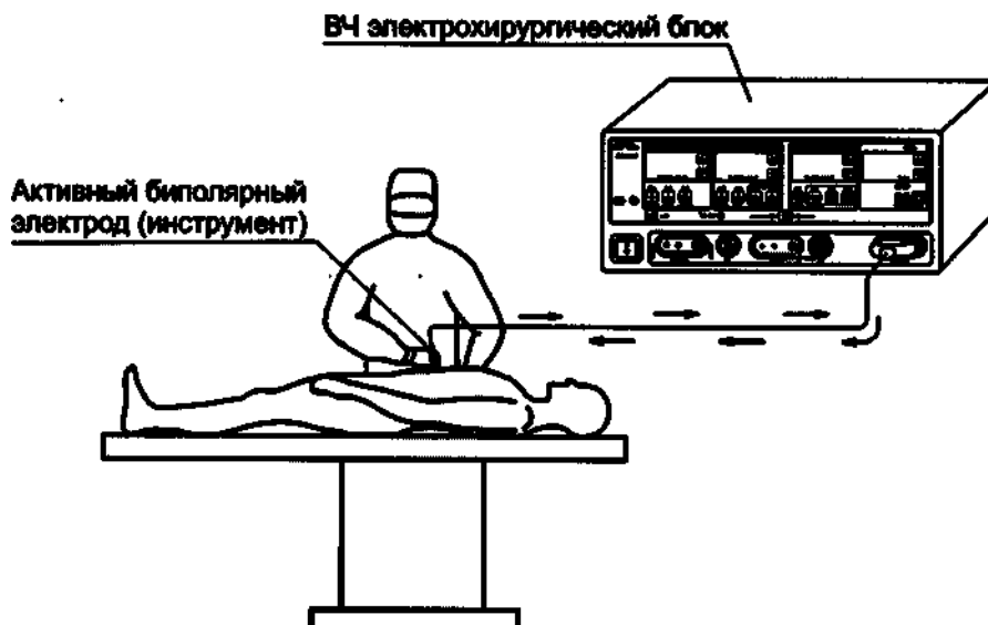
Рисунок 4 –Биполярный метод работы
