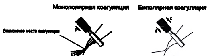
Рисунок 6 – Направление движения ВЧ тока при различных режимах работы
