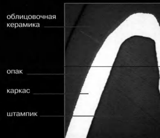
обжиг опак при температуре 980°C демонстрирует значительно лучшее сцепление
