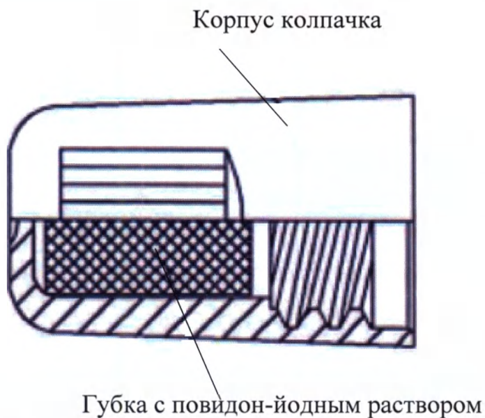
Рисунок 2. Схематическое изображение изделия «Колпачок отсоединяемый NOVADIAL с повидон-йодным раствором»
