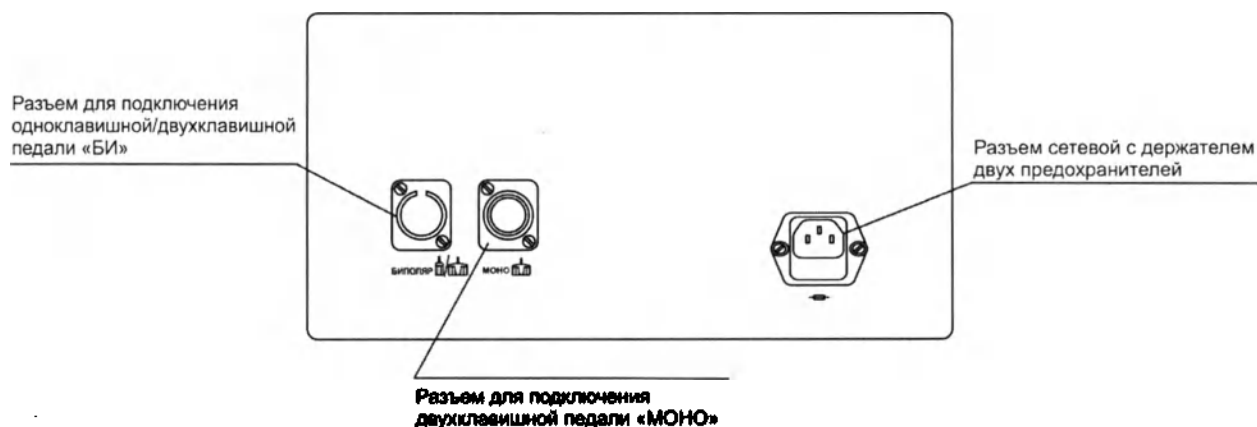
Рисунок 3 – Задняя панель блока управления аппаратов Е352М и Е354М
