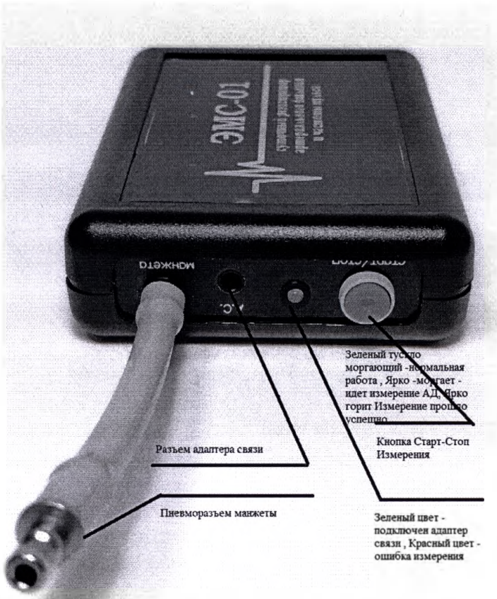
Рисунок 2 – Органы управления регистратора носимого «ЭМС-01»
