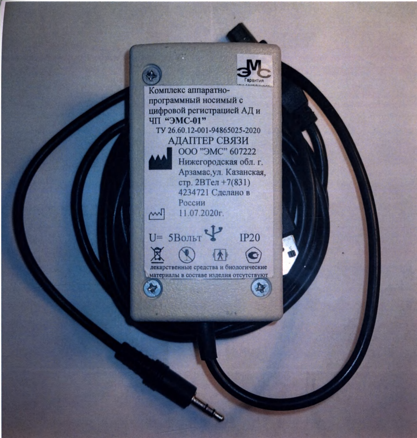
Фотографическое изображение 5 – Адаптер связи и кабель соединительный для подключения регистратора к ПК вид снизу
