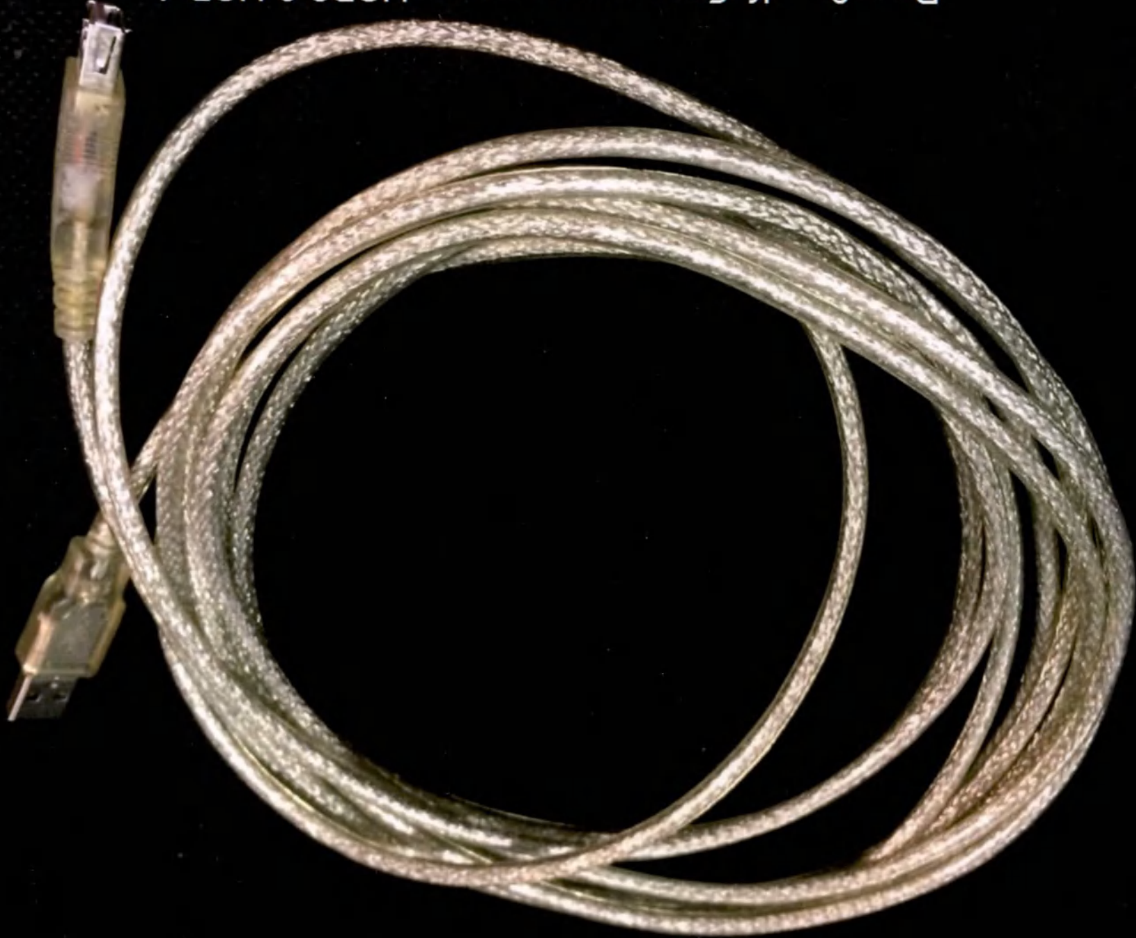
Рис. 9 - - Кабель-удлинитель USB2.0 USB A (м) - ■SB A (f) ферритовый фильтр 3м
