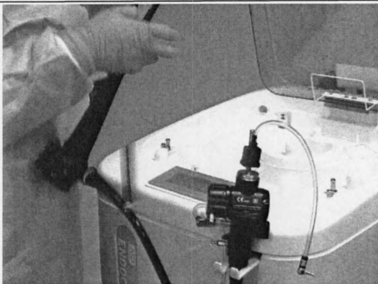
Рис. 24. Фиксация световода с помощью поддерживающего крюка.
