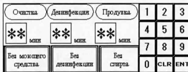
Рис. 49. Установка времени с помощью цифровой кнопочной панели
