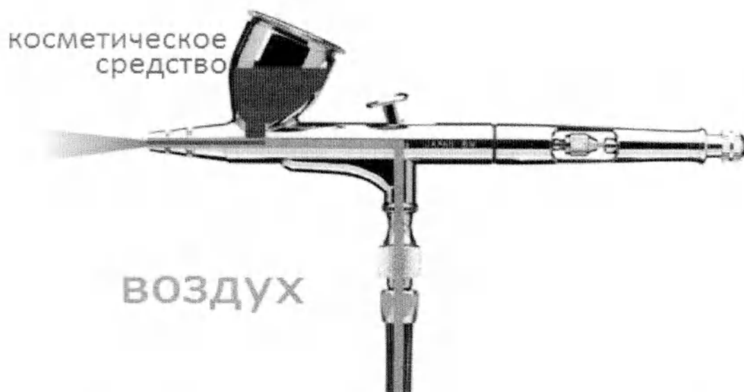
Рисунок 2 - Схематичное изображение работы манипулы для нанесения косметических средств.
