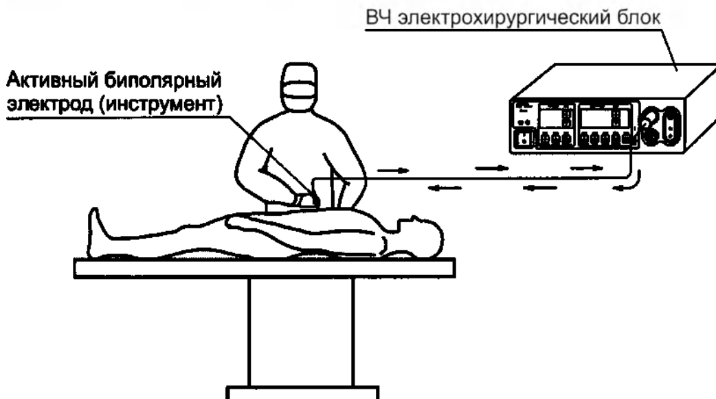
Рисунок 2 – Биполярный метод работы
