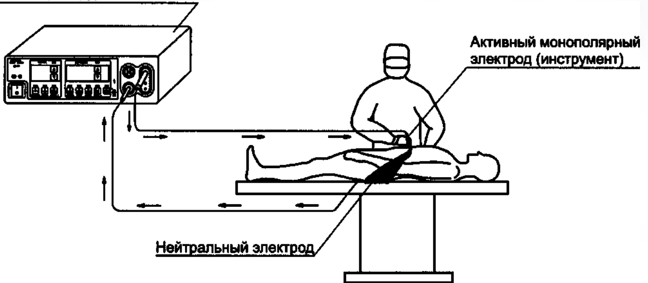
Рисунок 1 – Монополярный метод работы
