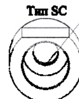
Шахта винта расположена под углом к правому углу плоской поверхности скан маркера, если смотреть с окклюзионной стороны (SC = Scanbody Corner)
