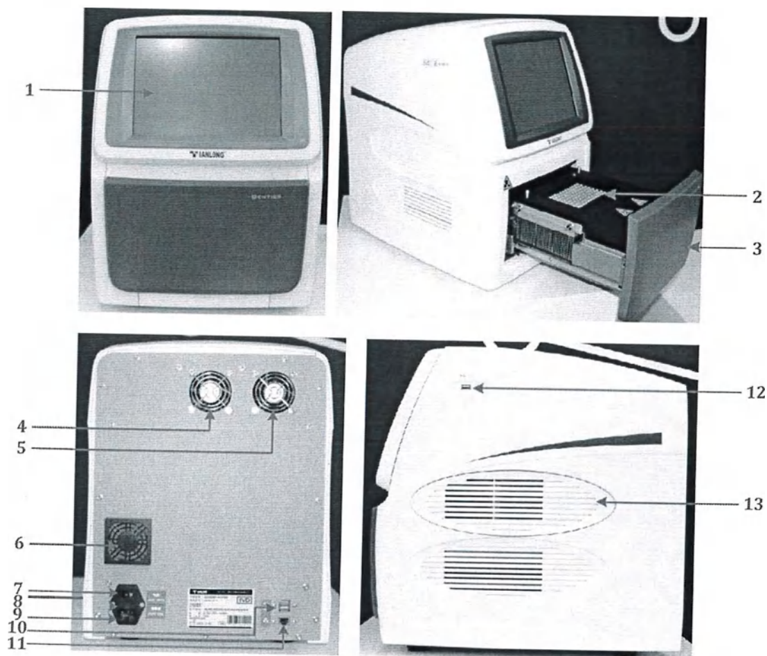
Рисунок А-1. Конструкция амплификатора FLUORITE®
