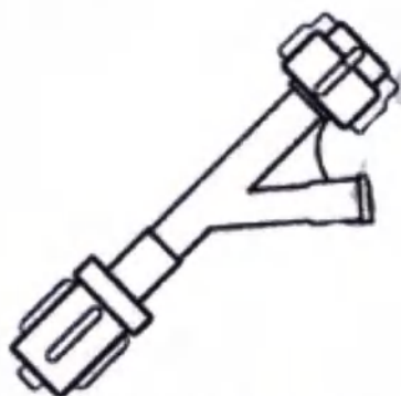
Рисунок 3. Схематическое изображение совместимого ротационного гемостатического клапана
