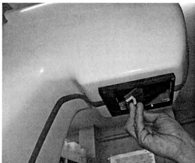
Рисунок 20 – Установка прямоугольной диафрагмы 18х24 см
