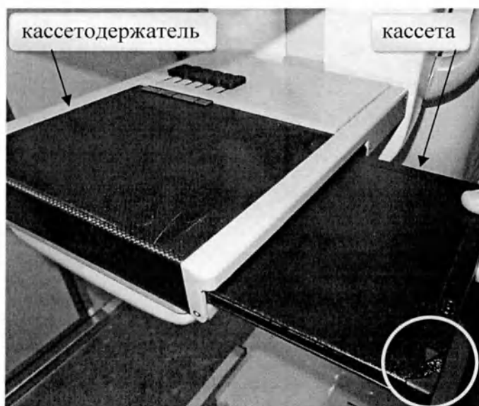
Рисунок 30 – Установка кассеты в кассетодержатель
