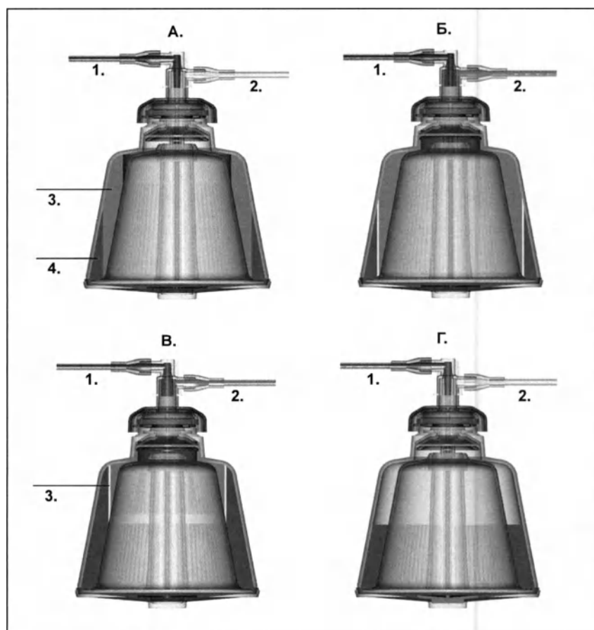
Рис. 4-8. Работа чаши Латама
