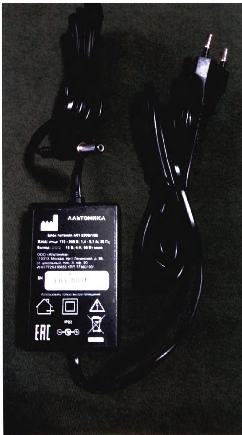
Блок питания сетевой А01 220В/15В Производства ООО «Альтоника», Россия Общий вид
