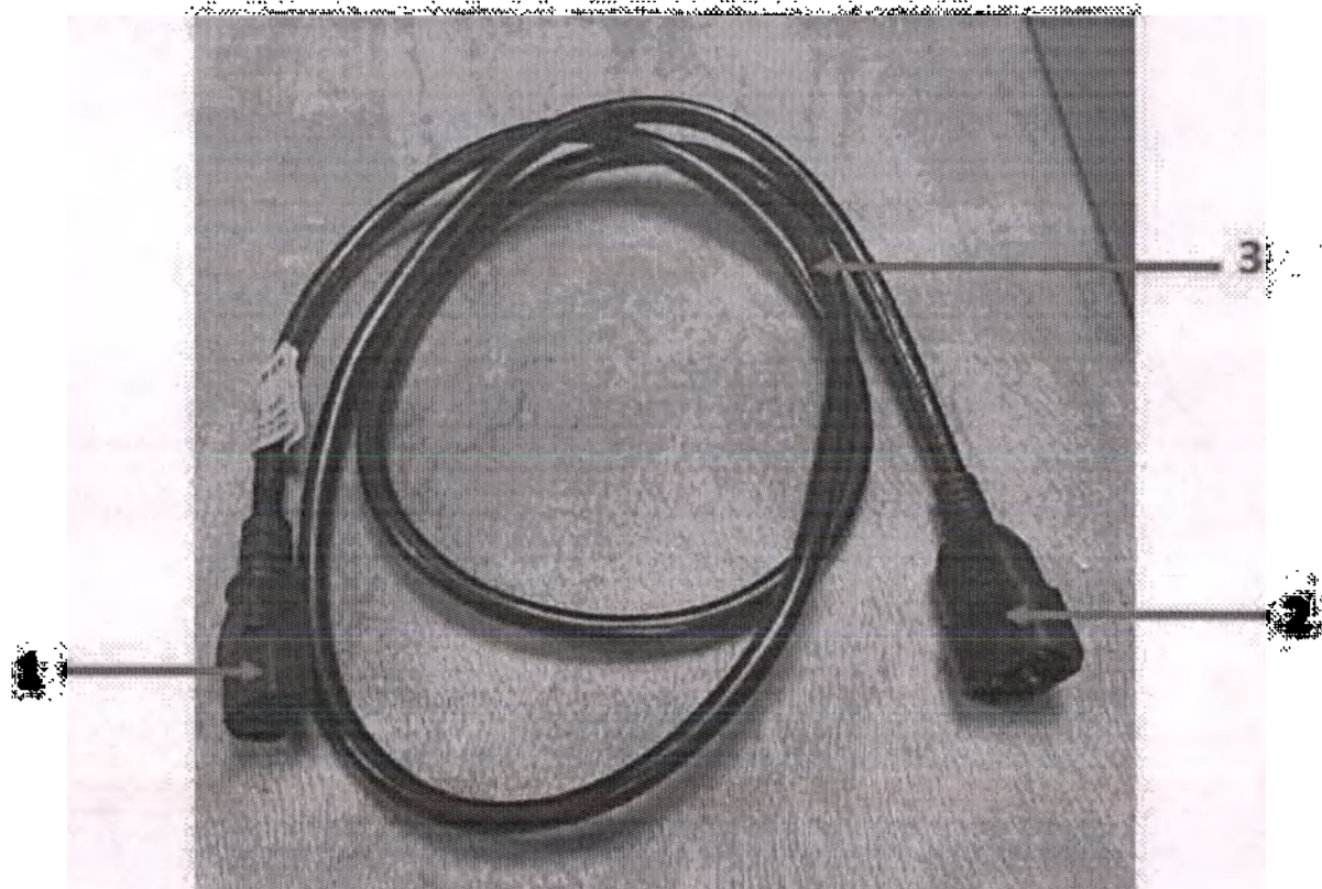
Рис. 1.8.20 Конструкция кабеля питания для фильтра питания (Power cord for the power filter)
