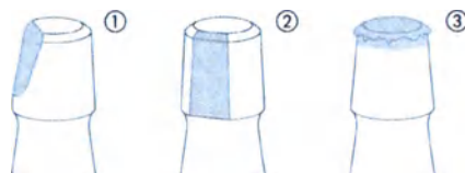
Рисунок 1.1 – 1.3: недопустимая деформация/повреждение конуса ножки.
