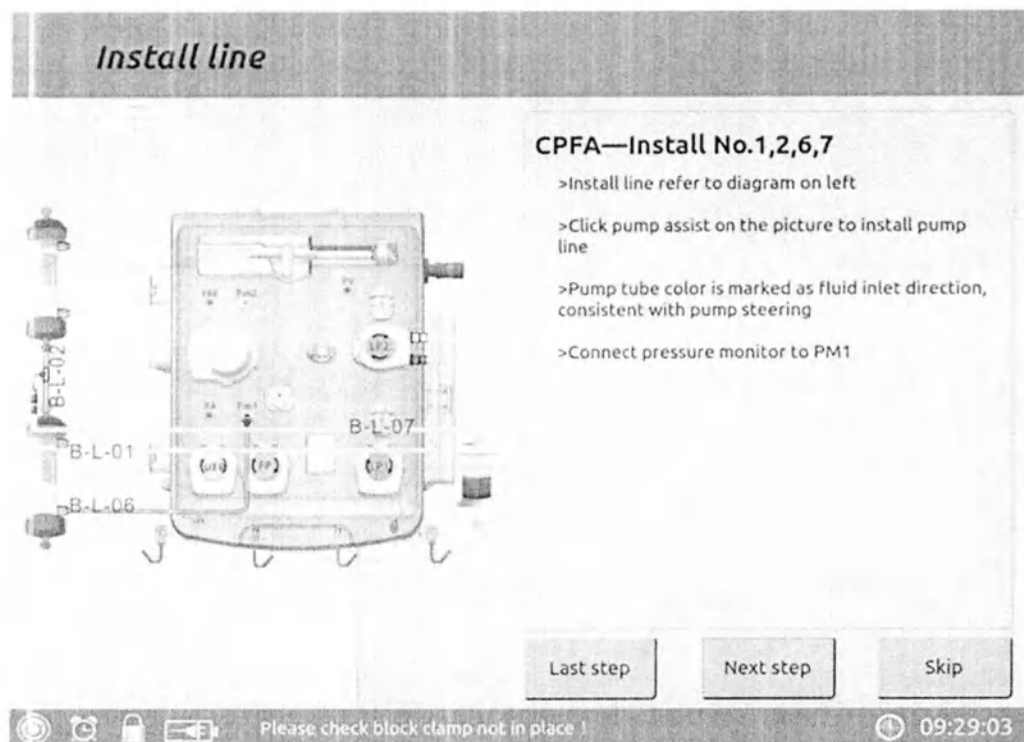
Рис 6-54 Установка магистралей для CPFA - Линии №1,2, 6, 7
