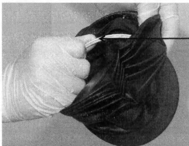
Кольцо верхней панели сильфона. Бороздки на соединительном кольце повернуты вниз.
