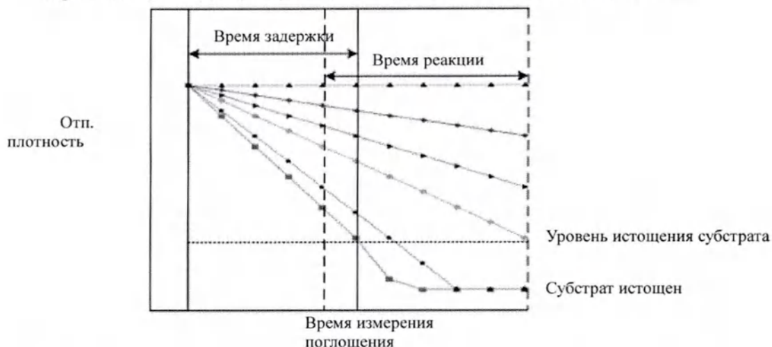
Figure 13.4 Кривая реакции с расширенным диапазоном линейности фермента
