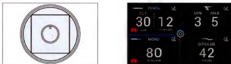
Рисунок 9 - Разъем для электрода лапароскопического монополярного, крючка и отображение интерфейса.
