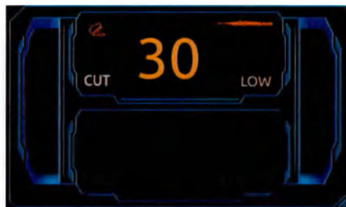
Рисунок 12 - Активация режима Разрез (CUT - Cutting) рукоятки для монополярных электродов SCPen.
