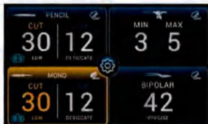
Рисунок 18 - Активация режима Разрез (CUT-Cutting) электрода лапароскопического монополярного, крючка в режиме Лапароскопического монополярного разреза (Laparoscopic Mono-Cut).
